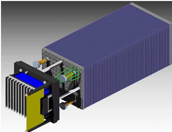
$Pb(0.35\text{ mm})+Scint.(1.5\text{ mm})$
